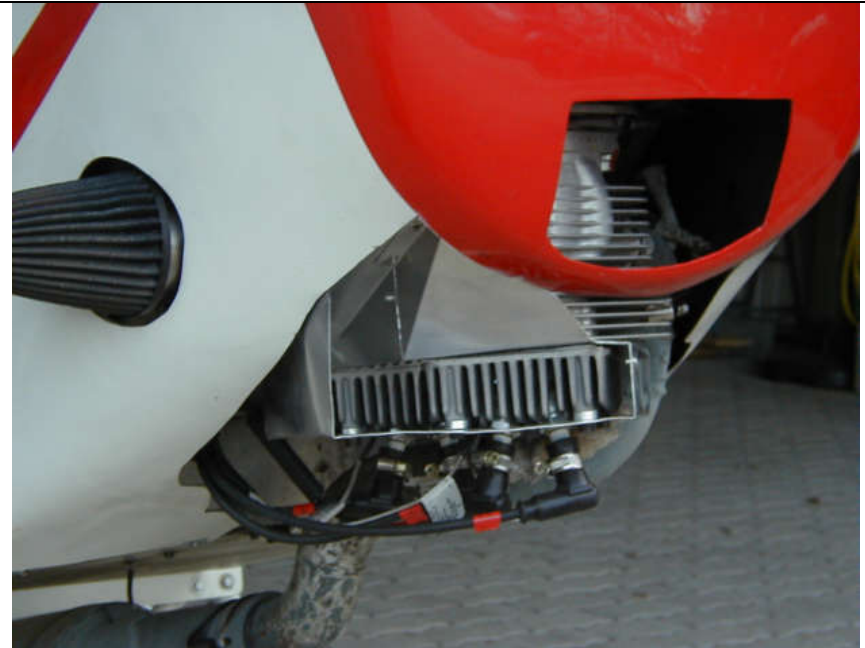
7. Mit Zwangsführung Temperaturunterschied CHT 1 + 2 = 10°C
