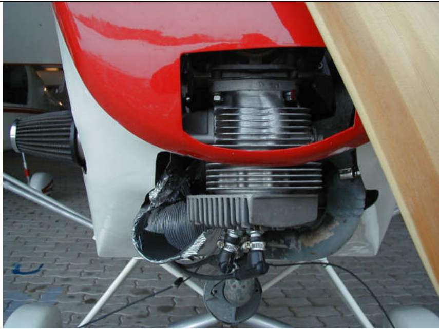
6. zwei Zylinder Reihenmotor Temperaturunterschied CHT 1 + 2 = 80°C
