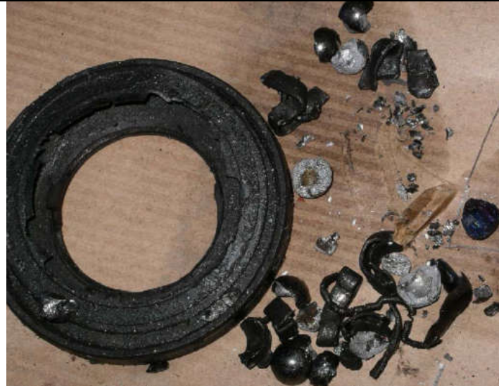
Vorderer Simmerring, Kugel- und Käfigreste
