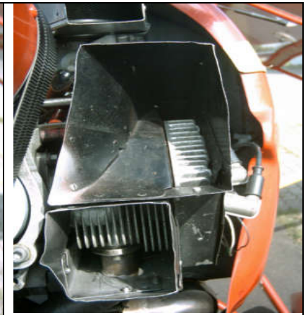
5. Kühlwege Zylinderköpfe und Laufbuchsen getrennt
