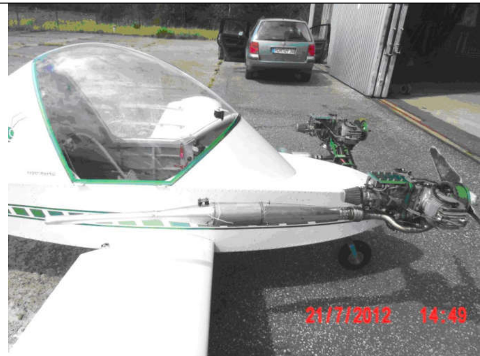
CriCri / 3W 275XiB2 TS Motor, ein Resonanzschalldämpfer Propeller 2 Blatt 30" x 24"
