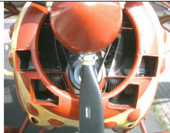
4. Luftbedarf und Form der Cowling fast unvereinbar
