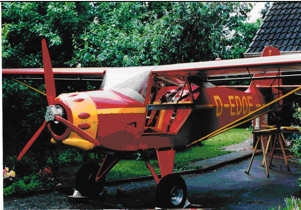
Vor dem Erstflug: Göbler- Hirth Abgasanlage und GH - Zahnriemengetriebe
