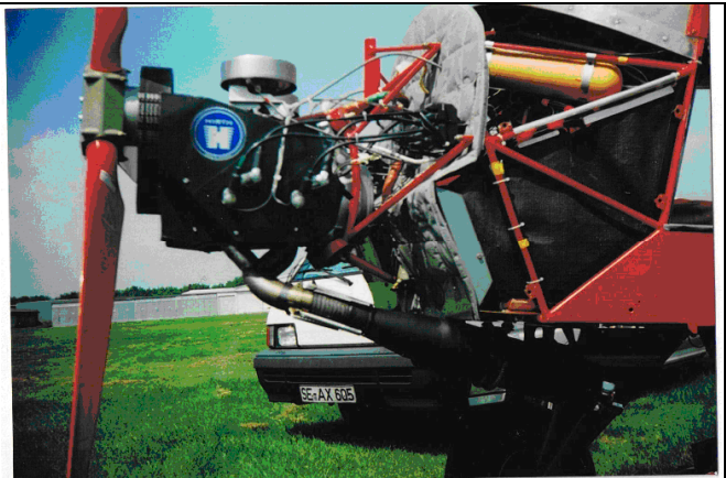
1. Umbau: Gokart Resonanzschalldämpfer RL=875 mm
