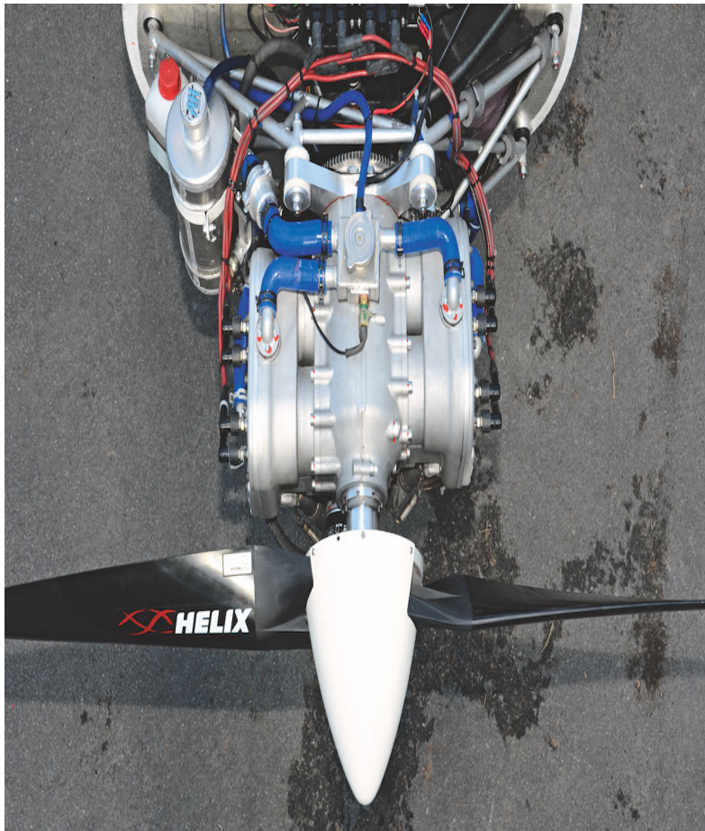
Schmal und leicht: LF26 im Speed Cruiser. Der großvolumige Boxer kommt ohne Getriebe aus
